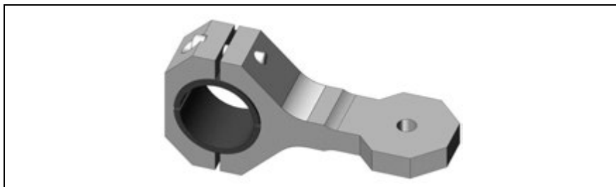
Fig. 3 Soporte para antorcha de corte automático
